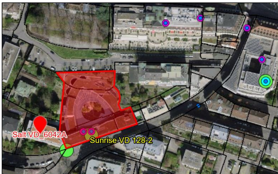
Figure 8-2 : Antennes émettrices dans le périmètre du PA « Alpha-Palmiers ». Vert : antennes 5G ; bleu clair : antennes 2G ; violet : antennes 3G ; bleu foncé : antennes 4G (source : www.geo.map.admin.ch).
