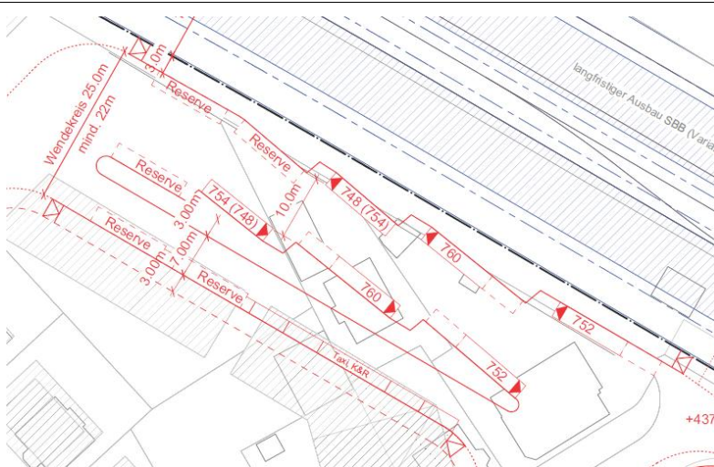
Abbildung 31: Sägezahn - Option mit zweiter Fahrgasse (zusätzliche Reservehaltetellen)
