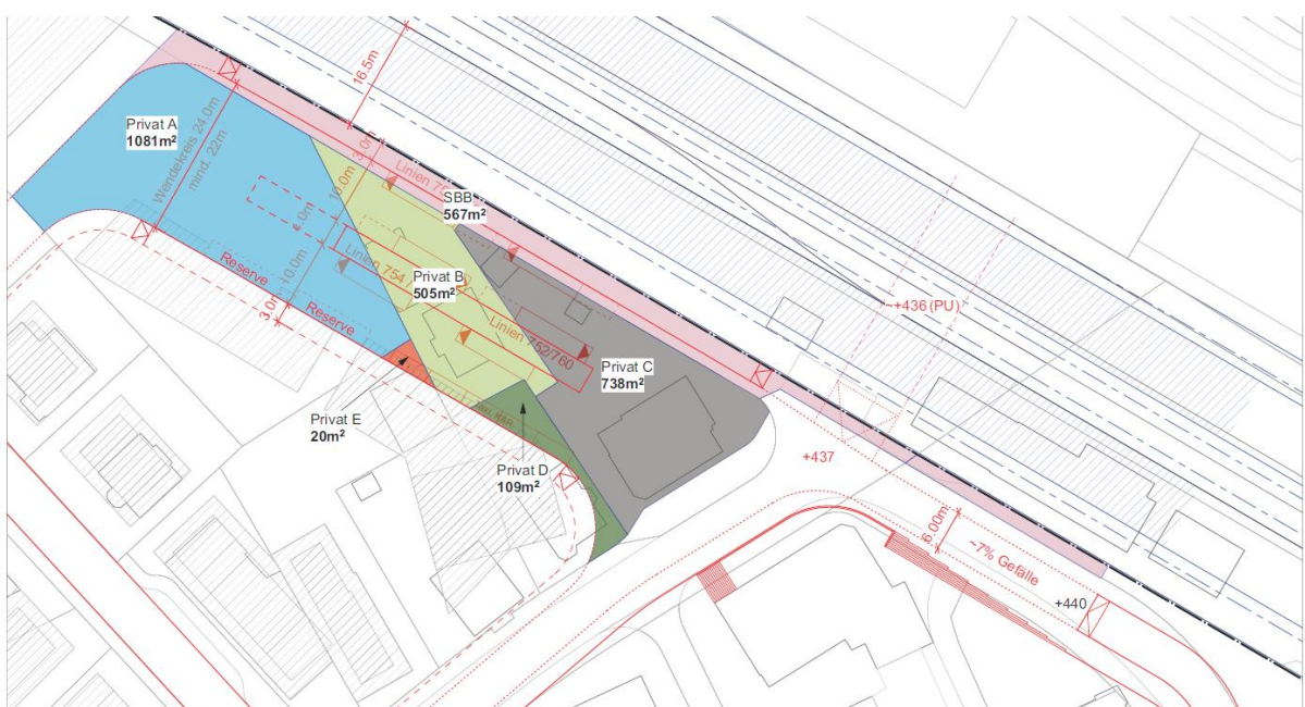
Abbildung 29: Flächenbeanspruchung Variante Fliesskanten parallel (2 Fahrgassen)
