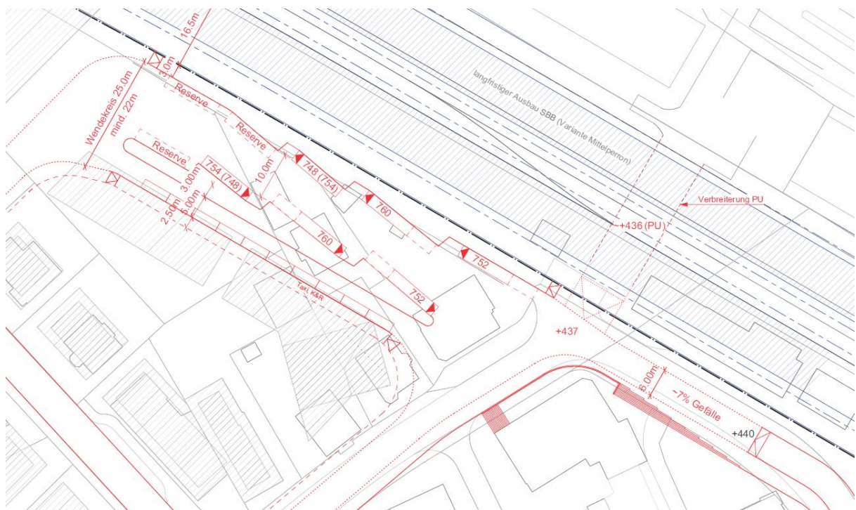
Abbildung 30: Linienführung Variante Sägezahn Seitenperron Bahnperrons gem. Prinzipskizze SBB (vgl. Abbildung 27), schraffierte Gebäude: Neuüberbauung gemäss Testplanung
